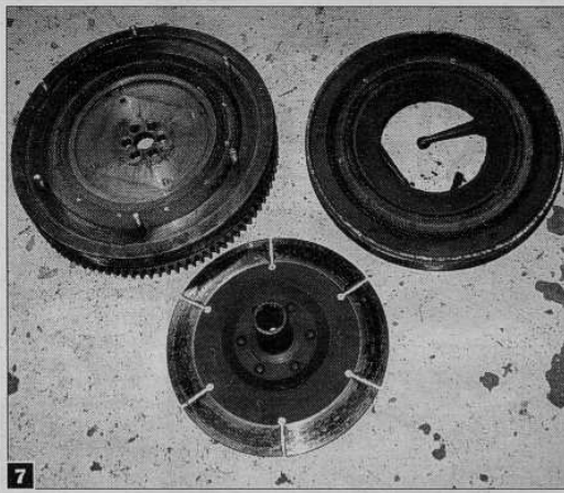
7 L'embrayage se dépose classiquement en dévissant les écrous sur la périphérie du mécanisme. Il s'agit d'un mécanisme Peugeot, montage des premières séries. Les fabrications plus récentes sont montées avec des mécanismes "Comète". Ici, les garnitures de friction ne sont pas rivetées sur le disque mais sur le volant-moteur et le plateau de pression. Le volant-moteur est donc déposé.
